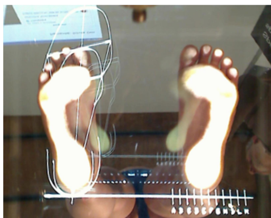
Figura 31: posizionamento dei piedi sul podoscopio (SprintIT srl, 2015).
